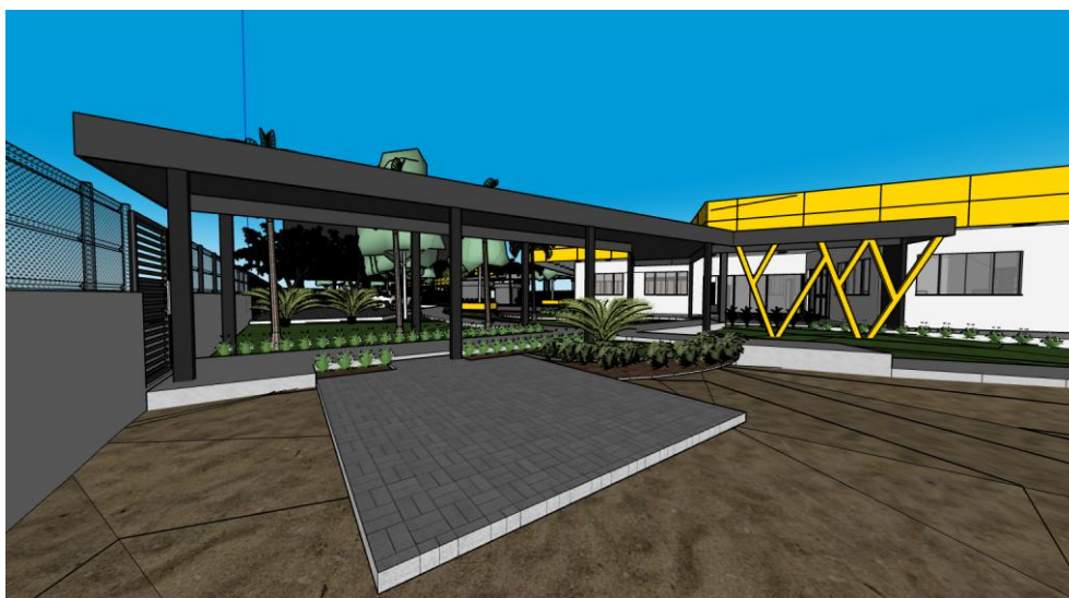
Figura 02 – Passarela de acesso principal – em estrutura metálica com telha metálica pintada de preto RAL9005.
