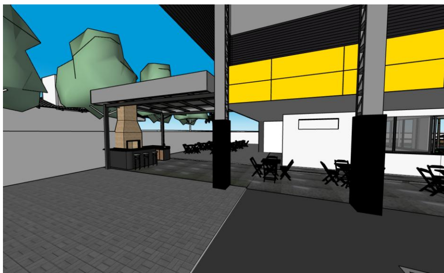
Figura 12 – Quiosque coberto lanchonete – em estrutura metálica com telha termoacústica com acabamento na parte inferior e superior, pintados na cor preto fosco.
