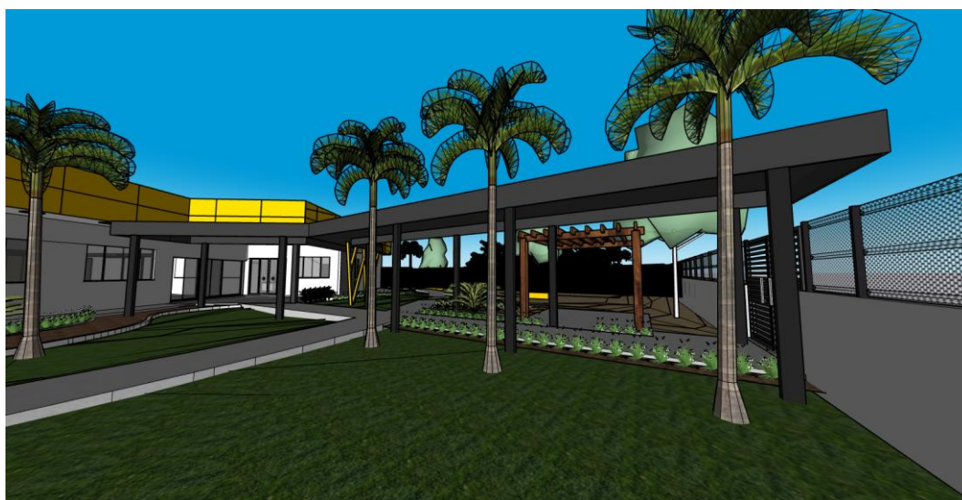
Figura 03 – Passarela de acesso principal – em estrutura metálica com telha metálica pintada de preto RAL9005.
