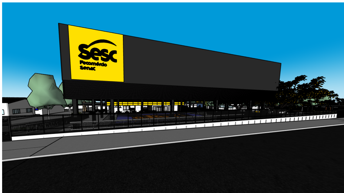
Figura 16 – Fechamento com brise e telha da ISOESTE cor preto em ambos os lados.
